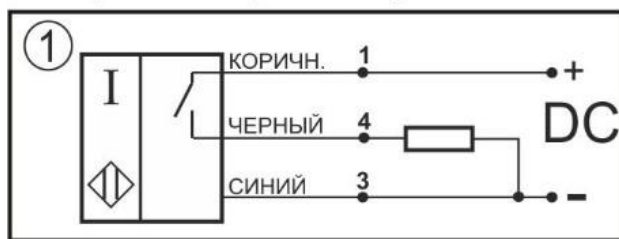
Схема соединения Нормально-разомкнутый контакт
